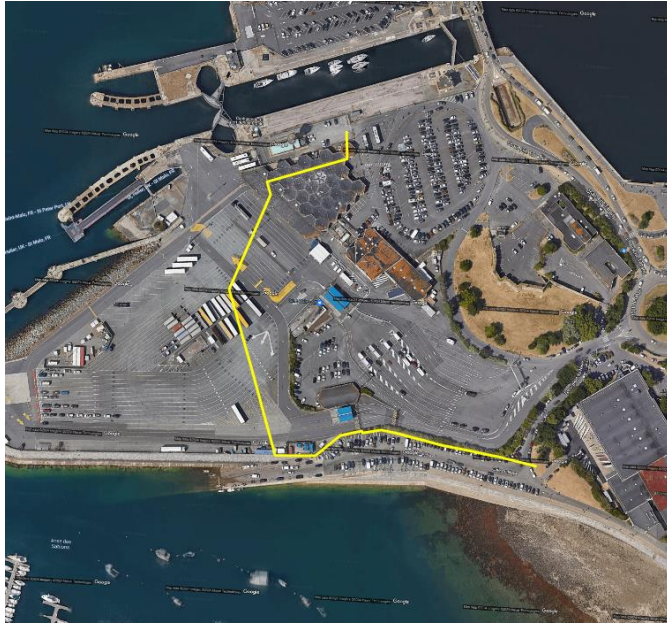
Réhausse du terminal du Naye : ligne de crête à 8.34 mNGF, représentée comme une digue dans le modèle
